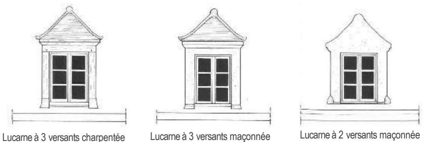
Les lucarnes traditionnelles – Source : La Maison rurale en Ile-de-France, Pierre Thiébaud
